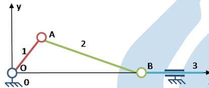
En conséquence, le torseur cinématique de la liaison pivot-glissant d'axe  $\vec{x}$  entre les solides 2 et 3 admet le simplification suivante :
